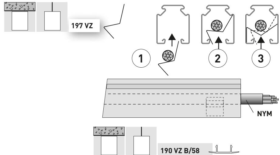
*(de) Blindabdeckungen 190 B/58 ablängen und zwischen zwei Leuchten in Tragschiene einsprengen.*
