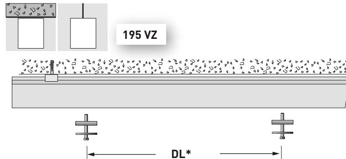
\* **de** Befestigungsmass der Leuchte, **en** suspension ponts of the luminaires,
