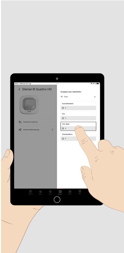
In diesem Menü können die **Funktionen** des Sensors aufgerufen und **einer oder mehreren Leuchtengruppen** zugeordnet werden.
